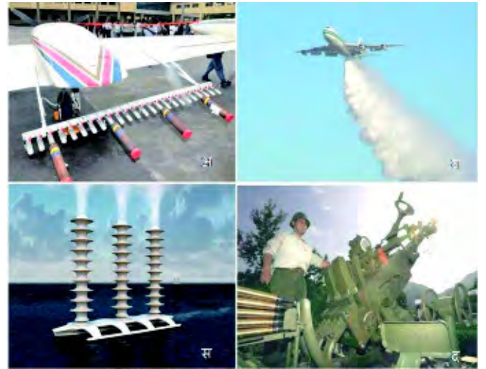
चित्र 2 : अ) हैदराबाद के बेगमपट हवाई अड्डे पर मेघबीजीकरण के लिए तैयार विमान। ब) विमान द्वारा AgI का स्प्रे। स) बादलों के रंग को हल्का करने के लिए टर्बाइन वाले जहाज का प्रारूप। द) चीन में मेघबीजीकरण के लिए इस्तेमाल किया जाने वाला एक रॉकेट लॉन्चर
